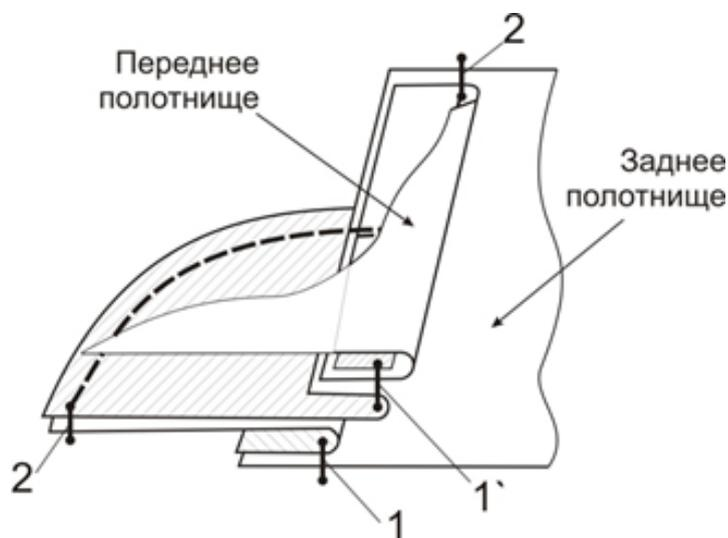
Рис. 1. Схема обработки кармана
