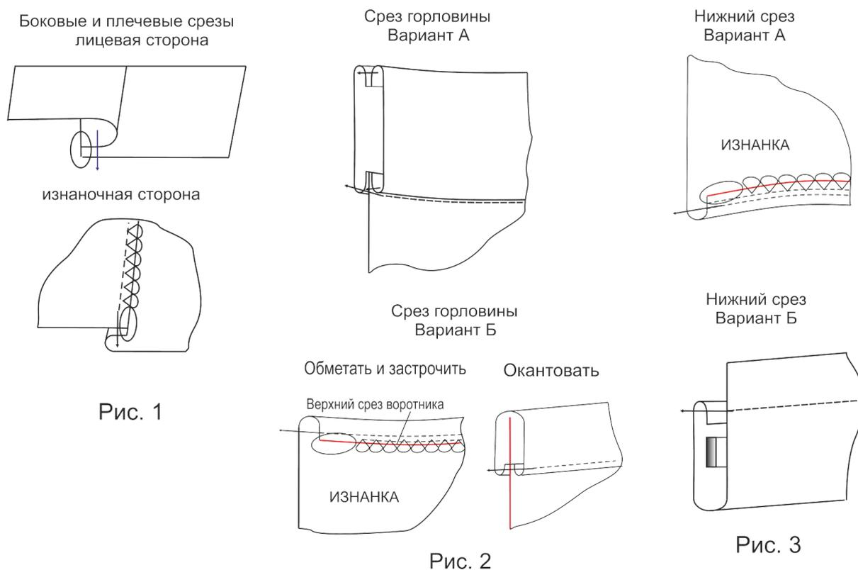
2. Обработайте верхний срез горловины по одному из предложенных ниже вариантов Рис. 2
