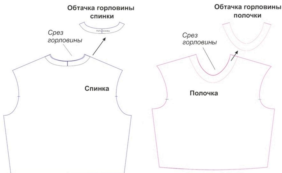
Рисунок 2. Схема построения подкройной обтачки горловины
