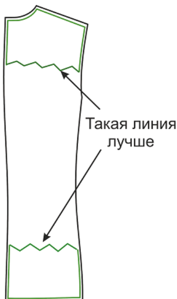
Рис. 1. Схема приклеивания ТПМ к спинке
