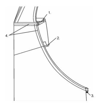
• Стачать средние швы на передней и задней частях брюк. Ширина шва 1,5 см. На закруглениях оттянуть утюгом припуски швов. Обметать срезы на оверлоке (или строчкой зиг-заг). Застрочить припуски двойной строчкой на одну сторону по лицевой стороне.
