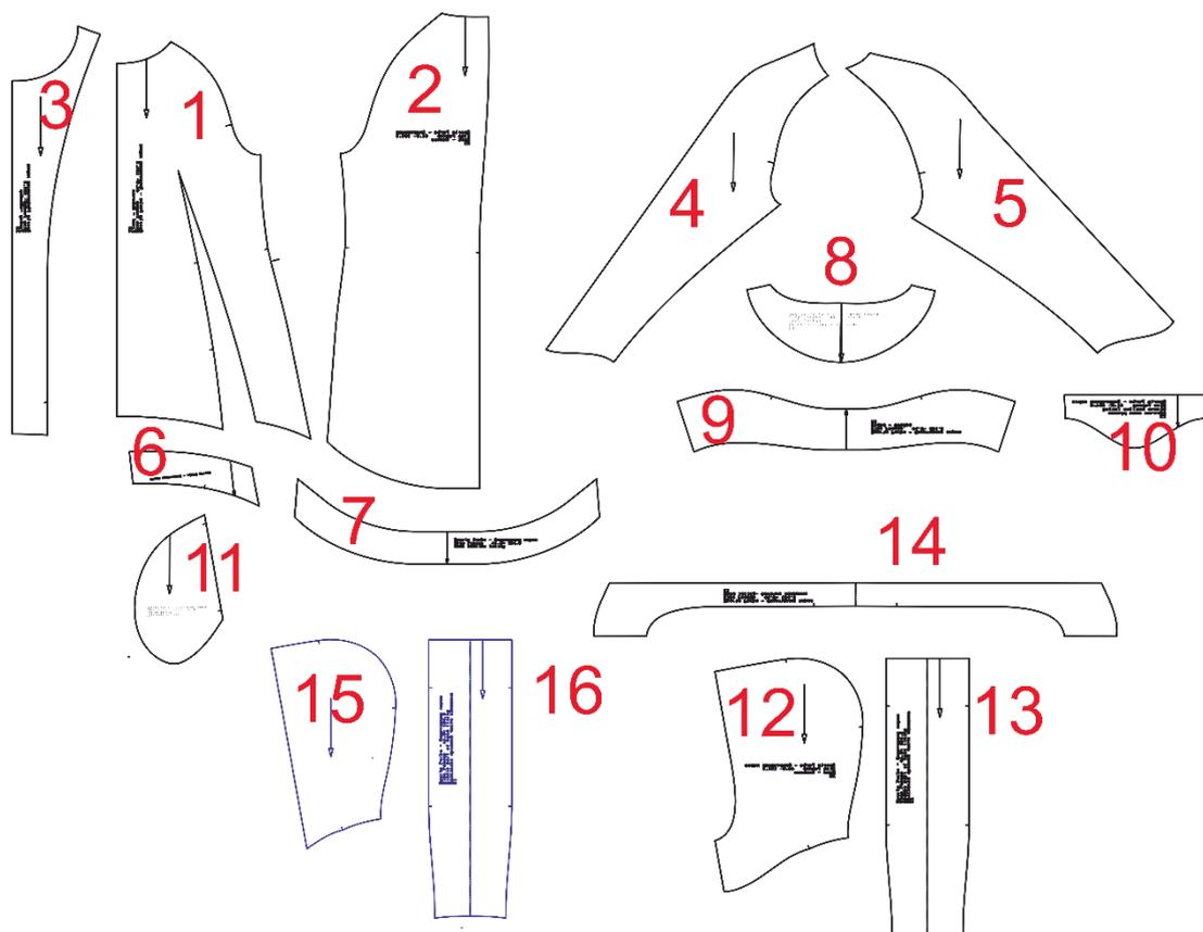
**Внимание!** При раскрое добавить припуски на швы: по всем соединительным срезам 10 мм.
