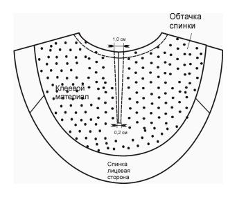
Рисунок 3. Обработка горловины спинки обтачкой
