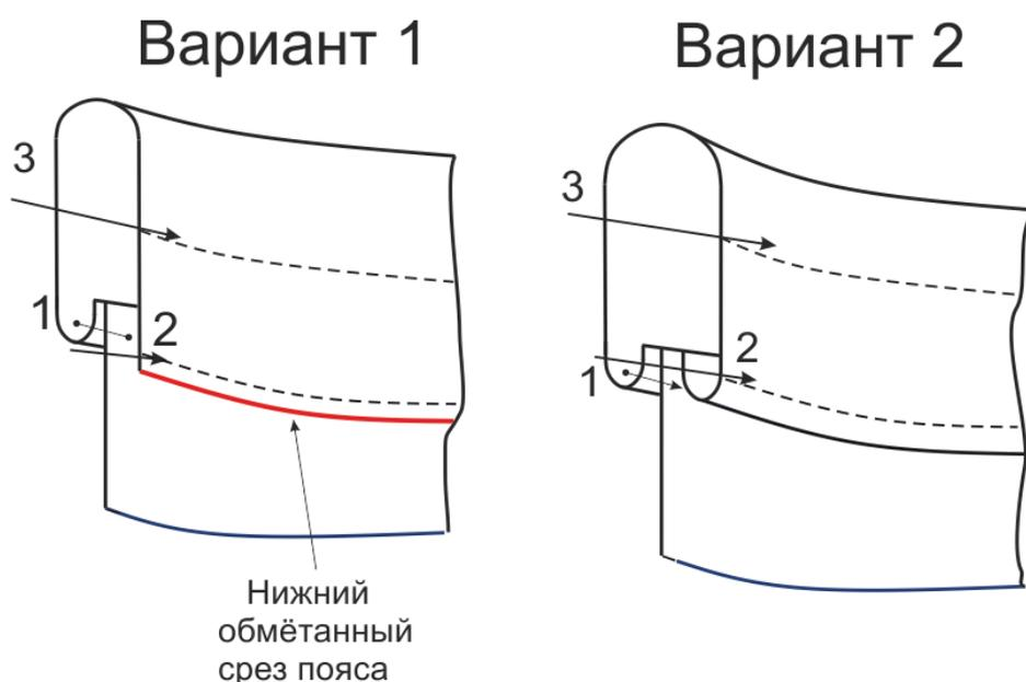
Рис. 2. Обработка верхнего среза шорт поясом
