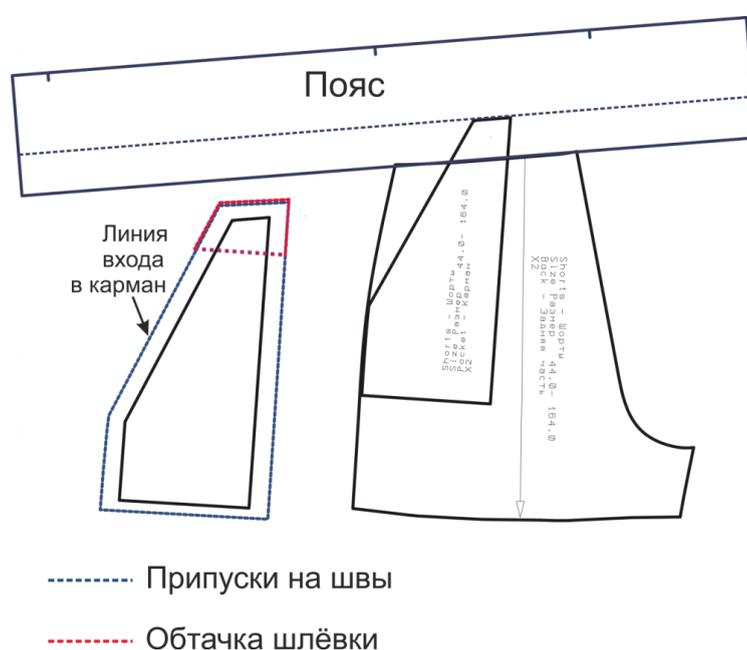
Рис. 1. Схема обработки передних шлёвок
