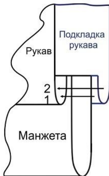
Рис. 1. Схема притачивания манжет к рукавам
