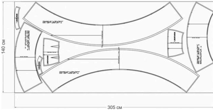
Схема раскладки деталей из подкладочного материала
