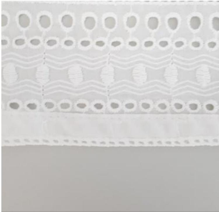
13. Низ юбки и подкладки юбки обработайте швом вподгибку с закрытым срезом.
