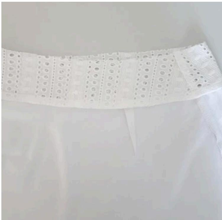
6. Сложите готовую подкладку кокетки и обтачку лицевыми сторонами внутрь. Уравняйте нижний срез обтачки с верхним срезом подкладки. Сметайте, совмещая боковые швы, а затем стачайте, шириной шва 10 мм. Срезы обметайте. Приутюжьте и заутюжьте в сторону подкладки.
