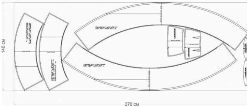
Схема раскладки деталей из подкладочного материала
