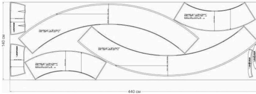
Схема раскладки деталей из подкладочного материала
