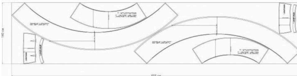
Схема раскладки деталей из подкладочного материала
