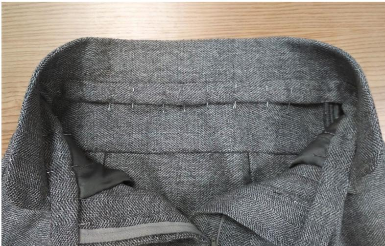
24. Притачайте к верхнему срезу юбки пояс. Для этого сложите укрепленную деталь пояса с изделием лицевой стороной внутрь. Приметайте, затем притачайте, шириной шва 10 мм. Приутюжьте и заутюжьте.
