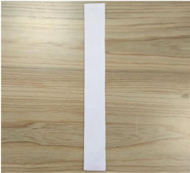
9. Сложите подзор застёжки пополам лицевыми сторонами внутрь. Уравняйте срезы. Верхний и нижний срез обтачайте, шириной шва 10 мм. Выверните на лицевую сторону. Расправьте по шву обтачивания и приутюжьте.
