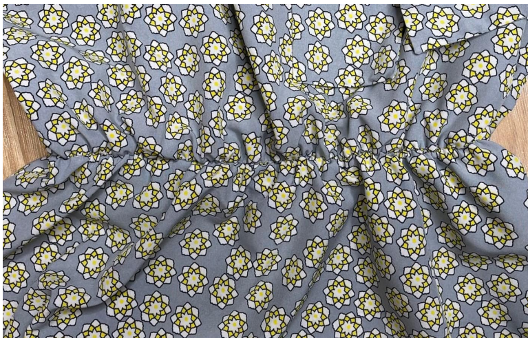
16. К талиевому припуску настройте эластичную резинку (длина резинки = От минус 10%) строчкой "зиг-заг".
