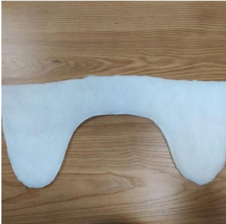
Если утеплитель выходит за срезы из основного материала, то лучше срезать излишек утеплителя.
