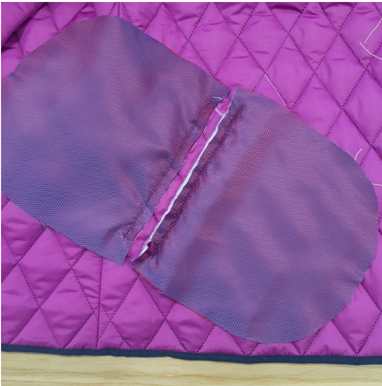
6. С изнаночной стороны полочки проверьте качество строчек. Строчки должны быть: параллельными, начинаться и заканчиваться на одном уровне, расстояние между ними должно быть равно ширине листочке в готовом виде.
