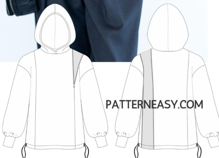
Женская толстовка прямой силуэтной формы большого объёма с капюшоном. Перед и спинка с рельефным швом с правой стороны. С левой стороны вставка с декоративной молнией. Линия плеч спущенная, рукав рубашечного кроя. Низ рукава на сборке и обработан манжетой из основного материала. По низу толстовки выполнена кулиска со шнуром и регулируемыми фиксаторами. Длина изделия чуть ниже линии бедер.
