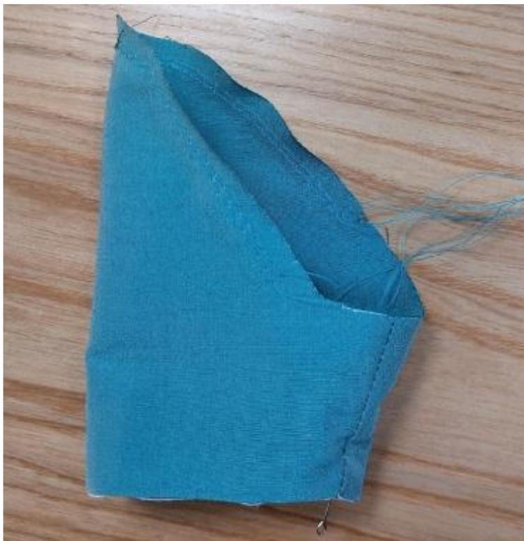
22. По окату рукава проложите две машинные строчки с максимальной шириной стежка, без закрепок. Первая строчка: 5 мм от среза, вторая: 9 мм. Оставьте длинные концы (5-7 см) для последующей сборки. Соберите на сборку за счет вытягивания нижних нитей от строчек.
