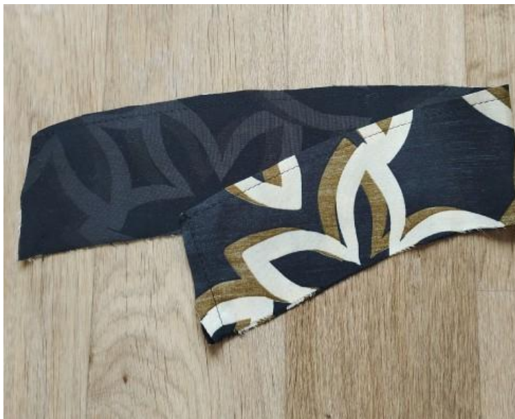
17. Сложите воротник лицевыми сторонами внутрь. Уравняйте срезы отлета и концов. Сколите, обтачайте, шириной шва 10 мм. Приутюжьте. Срежьте припуски в уголках, для лучшего выправления. Припуски среза отлета подрежьте до 0,5 мм. Выверните, выправите по шву и в уголках. Выметайте края ручными косыми стежками. Приутюжьте.
