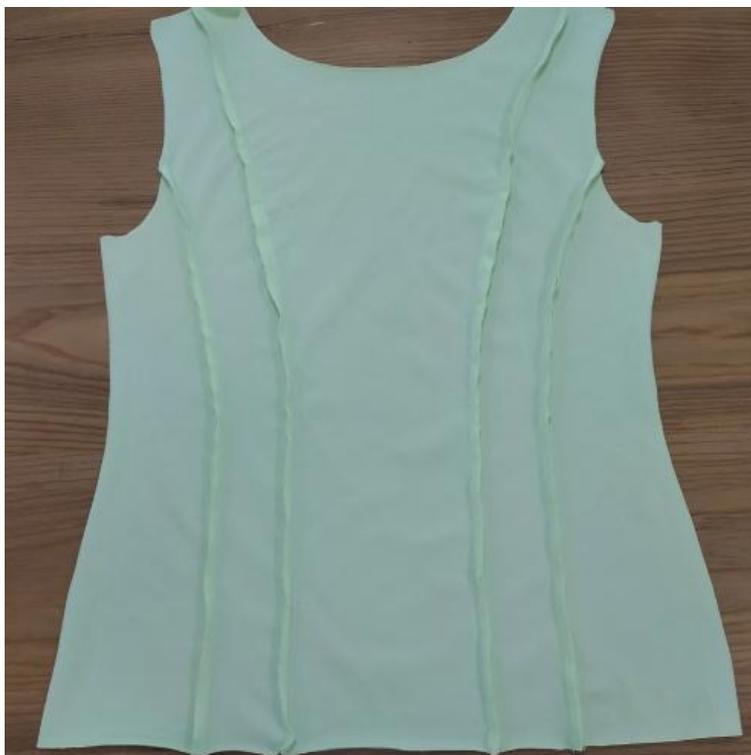
4. Стачайте шириной шва 7 мм на плоскошовной машине. Приутюжьте швы.
