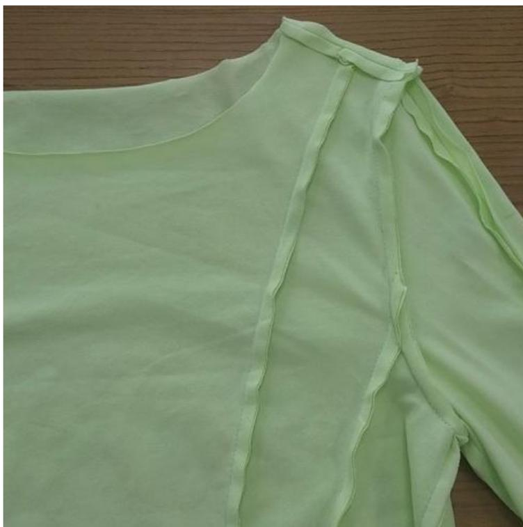
8. Втачайте шириной шва 7 мм на плоскошовной машине. Приутюжьте.
