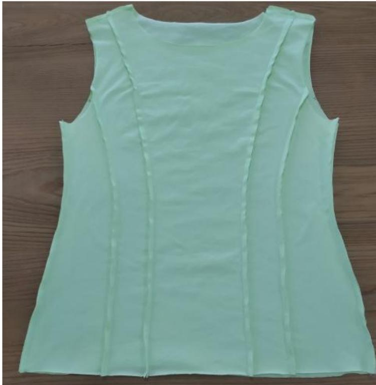
5. Изнаночными сторонами внутрь сложите детали переда и спинки. Уравняйте плечевые и боковые срезы. Сколите, сметайте. Стачайте шириной шва 7 мм на плоскошовной машине. Приутюжьте. Плечевые швы приутюжьте и разутюжьте.
