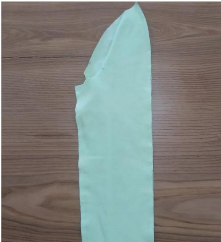
6. Изнаночной стороной внутрь сложите детали передней и задней частей рукава. Уравняйте срезы. Сколите, сметайте. Стачайте шириной шва 7 мм на плоскошовной машине. Верхние припуски рукава разутюжьте.
