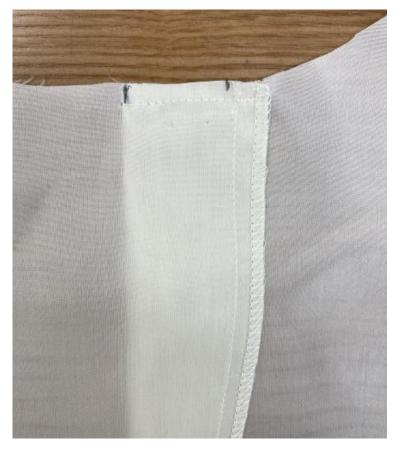
44. Заложите сверху складку на спинке строго по меткам. Проложите строчку шириной шва 5 мм. Приутюжьте и заутюжьте в сторону складки.
