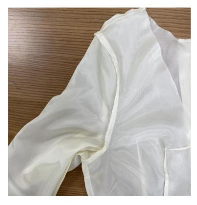
49. Вложите рукав подкладки в пройму изделия подкладки лицевыми сторонами внутрь. Уравняйте срезы соединения. Вколите, совмещая контрольные метки. Сметайте. Стачайте, шириной шва 10 мм. Обметайте срезы. Приутюжьте и заутюжьте припуски в сторону рукава.
