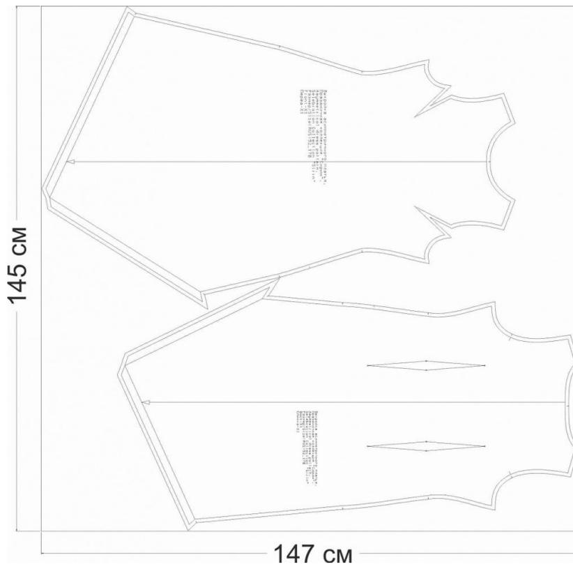
**Схема раскладки из подкладочного материала размер 52/170**
