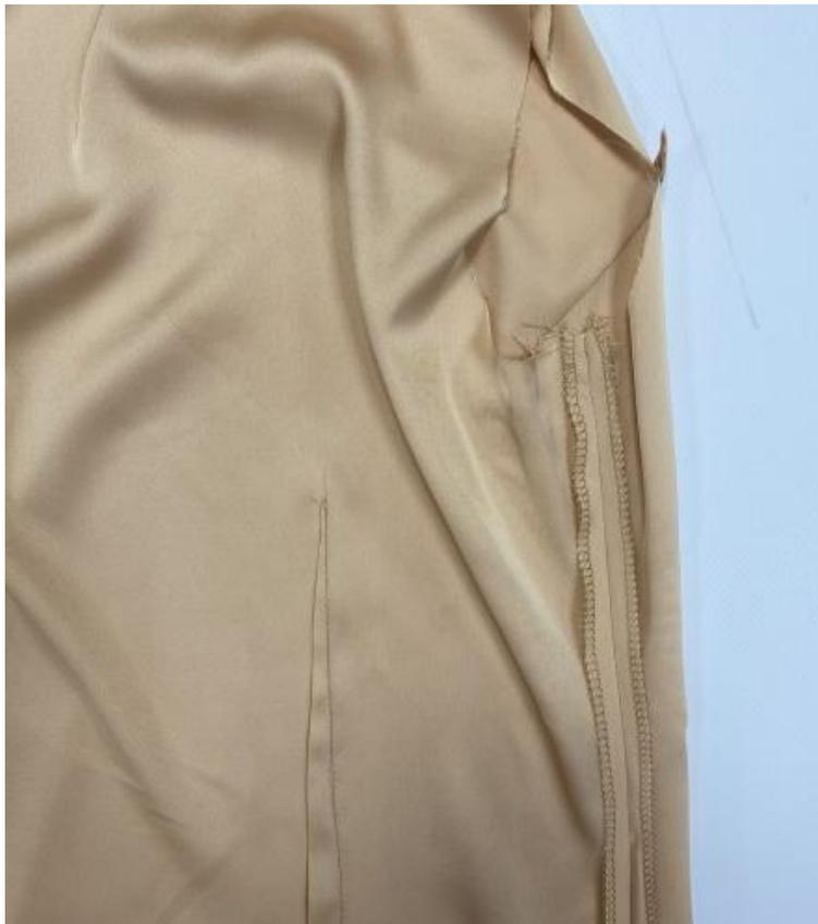
14. Сложите лицевыми сторонами подкладку переда и подкладку спинки, уравняйте боковые срезы, сколите, сметайте, стачайте шириной шва 10 мм. Обработайте срезы на оверлоке. Приутюжьте и разутюжьте припуски.
