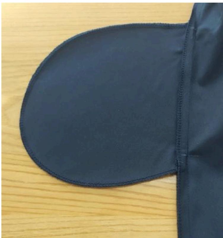
7. Сложите перед и спинку лицевыми сторонами внутрь. Уравняйте боковые срезы. Сколите, стачайте, шириной шва 10 мм, от верхнего среза до контрольной метки «начало входа в кармана», затем от контрольной метки «конец входа в карман» до нижнего среза. Приутюжьте и разутюжьте.
