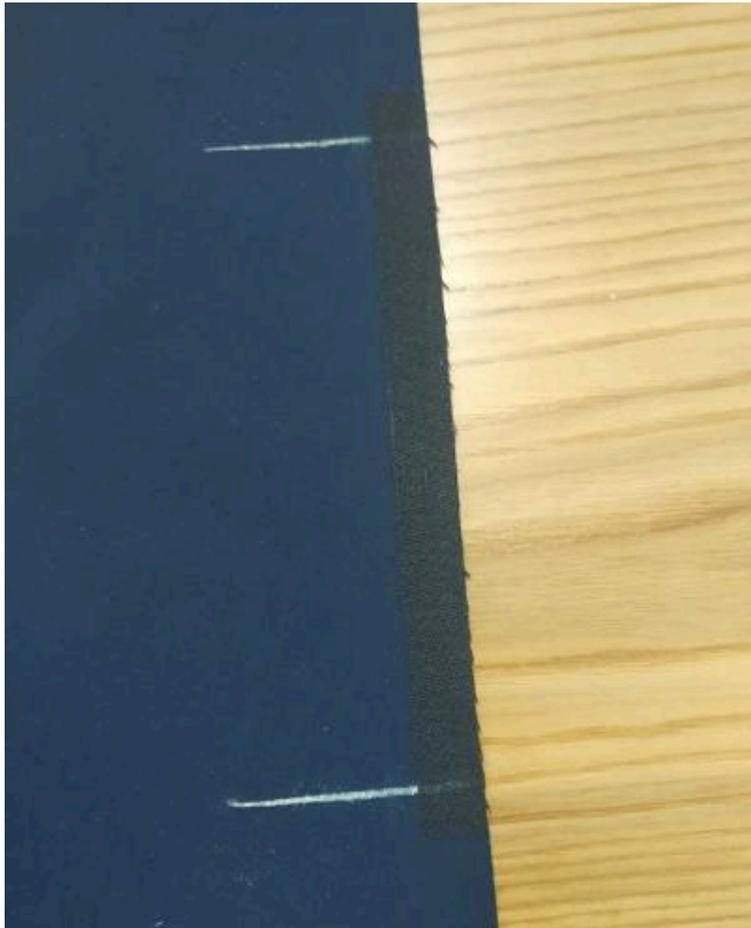
2. Укрепите клеевой припуск входа в карман на деталях переднего полотнища с изнаночной стороны, заходя на 1 см за контрольные метки.
