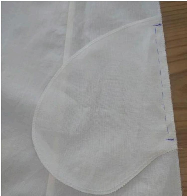
4. Притачайте, шириной шва 10 мм, строго от одной контрольной метки до другой.
