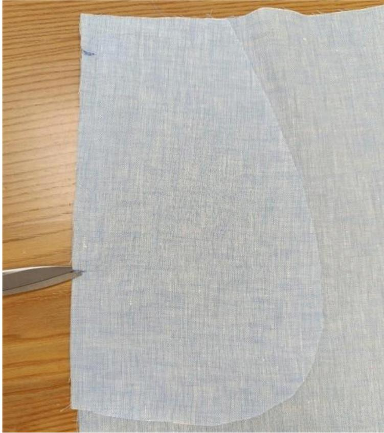
3. Сделайте рассечки на припусках мешковины и передних половинках брюк, не доходя до шва на 1-2 мм, в местах где обозначен метками вход в карман.
