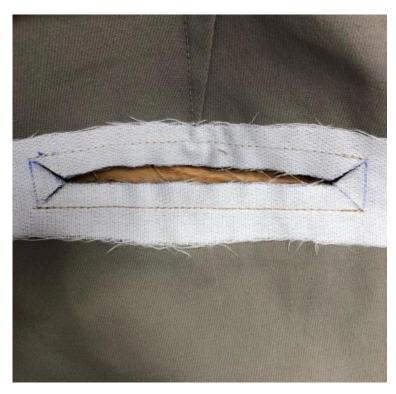
9. Разрежьте вход в карман: посередине между строчками, сначала в одну сторону, а затем в другую, не доходя до конца кармана на 10-15 мм. А далее разрежьте наклонно к строчкам, не доходя до них на 1 мм.
