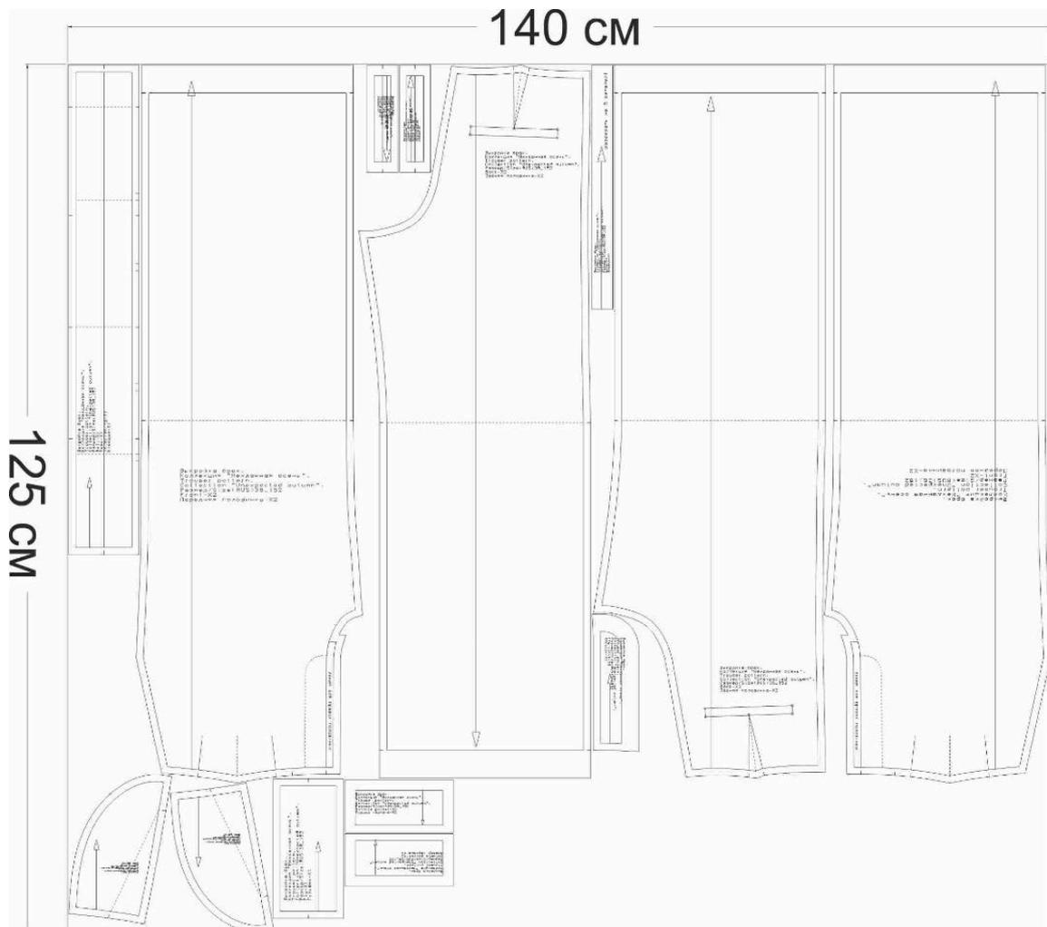
**Схема раскладки размер 36/152, подкладочный материал**
