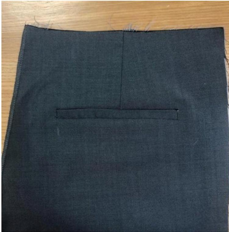
13. Разрежьте вход в карман: посередине между строчками, сначала в одну сторону, а затем в другую, не доходя до конца кармана на 10-15 мм. А далее разрежьте наклонно к строчкам, не доходя до них на 1 мм. Выверните, выправите по швам, сформировав карман в готовом виде.
