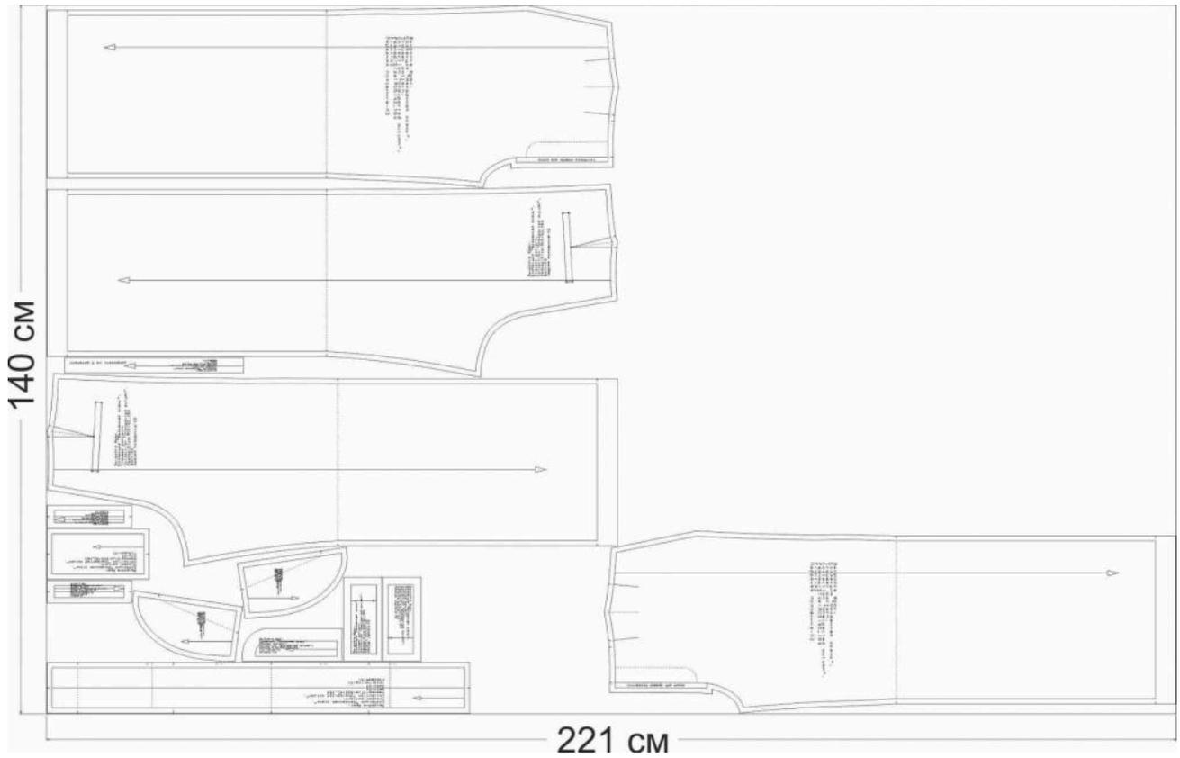
**Схема раскладки размер 42/164, подкладочный материал**
