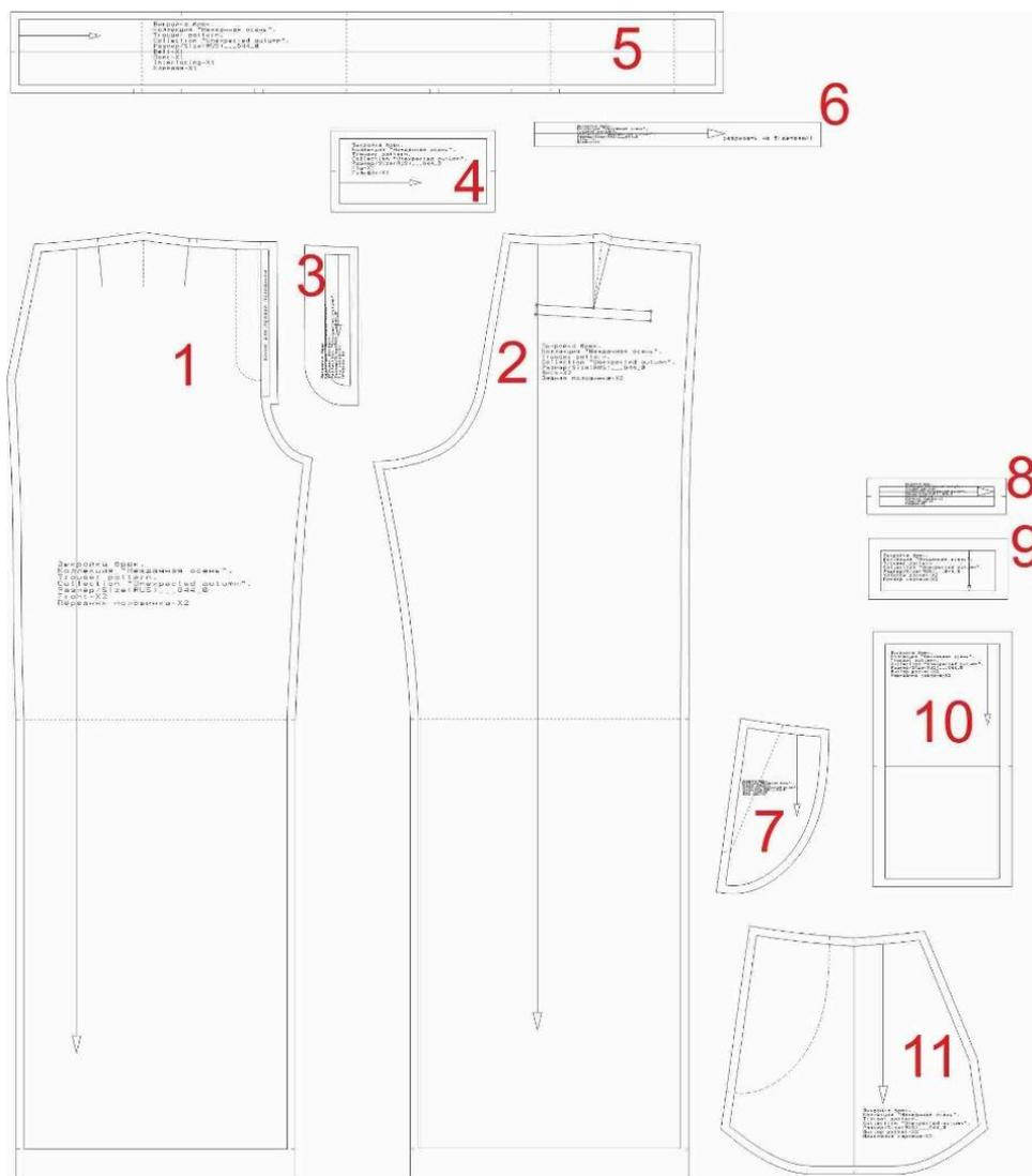
**Схема раскладки размер 36/152, основной материал**
