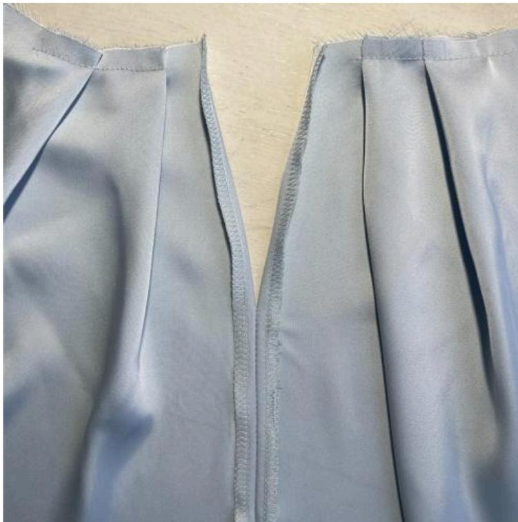
23. Левый боковой шов стачайте от контрольной метки втачивания потайной молнии до низа изделия. Шов приутюжьте, затем разутюжьте.
