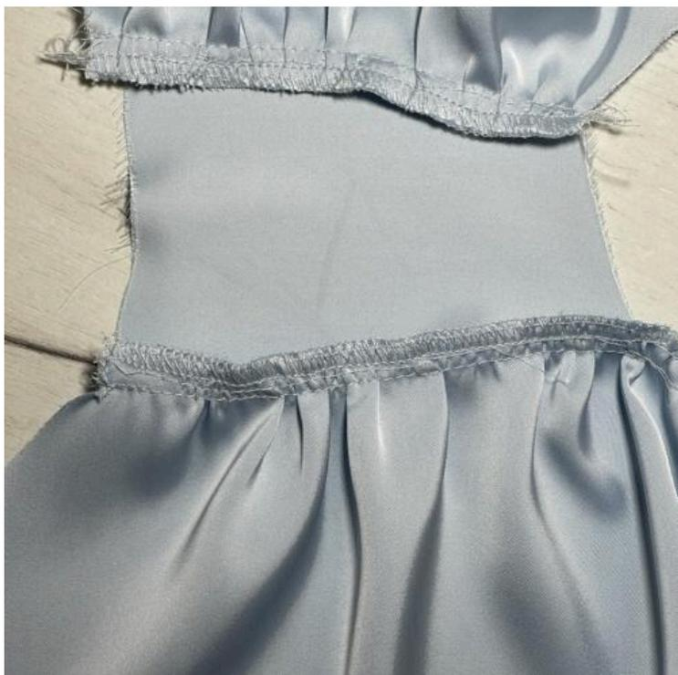
4. По плечевому срезу спинки проложите две машинные строчки с максимальной шириной стежка, без закрепок. Оставьте длинные концы (5-7 см) для последующей сборки. Соберите сборку за счет вытягивания нижних нитей строчек. Распределите сборку равномерно по всей длине.
