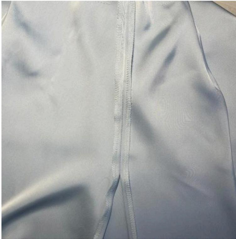
22. Переднюю и заднюю части юбки сложите лицевыми сторонами внутрь, стачайте правый боковой шов от верхнего среза юбки вниз до контрольной метки. Шов приутюжьте, затем разутюжьте.
