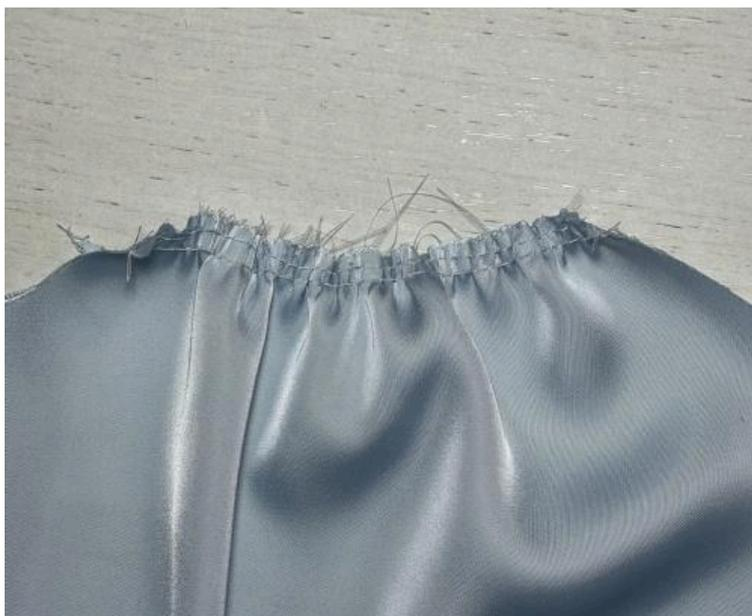
2. По плечевому срезу полочки проложите две машинные строчки с максимальной шириной стежка, без закрепок. Оставьте длинные концы (5-7 см) для последующей сборки. Соберите сборку за счет вытягивания нижних нитей строчек. Распределите сборку равномерно по всей длине.
