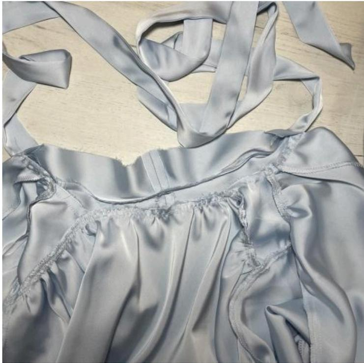
32. По припуску горловины проложите две машинные строчки с максимальной шириной стежка, без закрепок. Оставьте длинные концы (5-7 см) для последующей сборки. Соберите на сборку за счет вытягивания нижних нитей строчек. Распределите сборку равномерно по всей длине.
