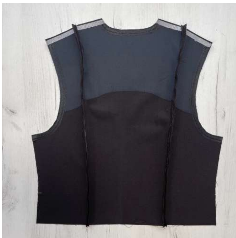
10. Лицевыми сторонами внутрь сложите детали центральной части спинки и бочка спинки. Уравняйте рельефные срезы, сколите, сметайте, стачайте шириной шва 10 мм. Приутюжьте и заутюжьте припуски в центр.
